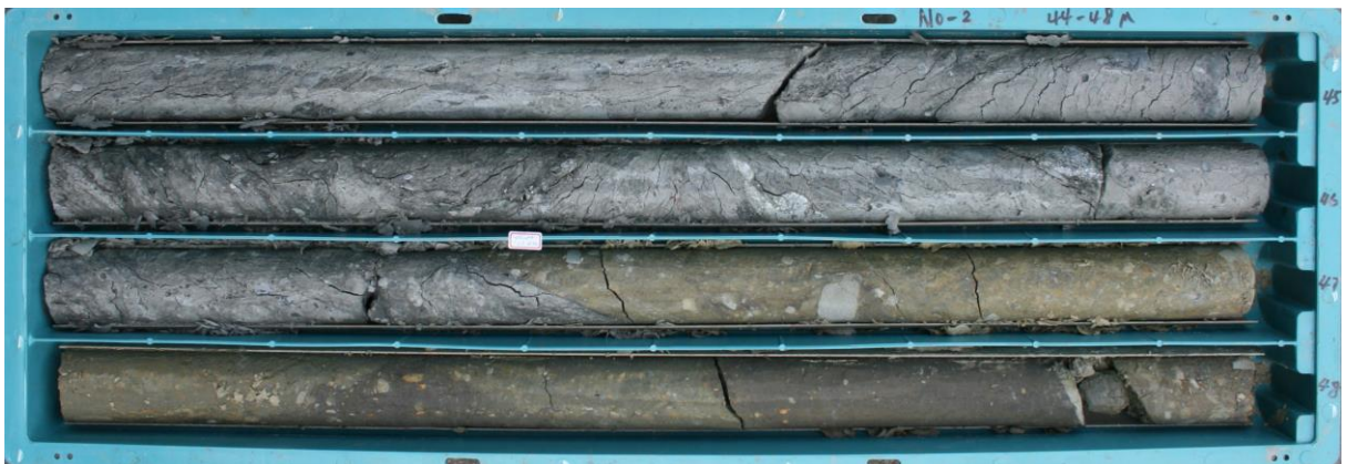
圖 4-10 池上斷層地質鑽探(保安宮 2 號井)岩心，46.4 公尺以上為利吉層構成之上盤剪裂帶，以下為黃棕色之階地礫石，46.4 公尺為斷層位置。
