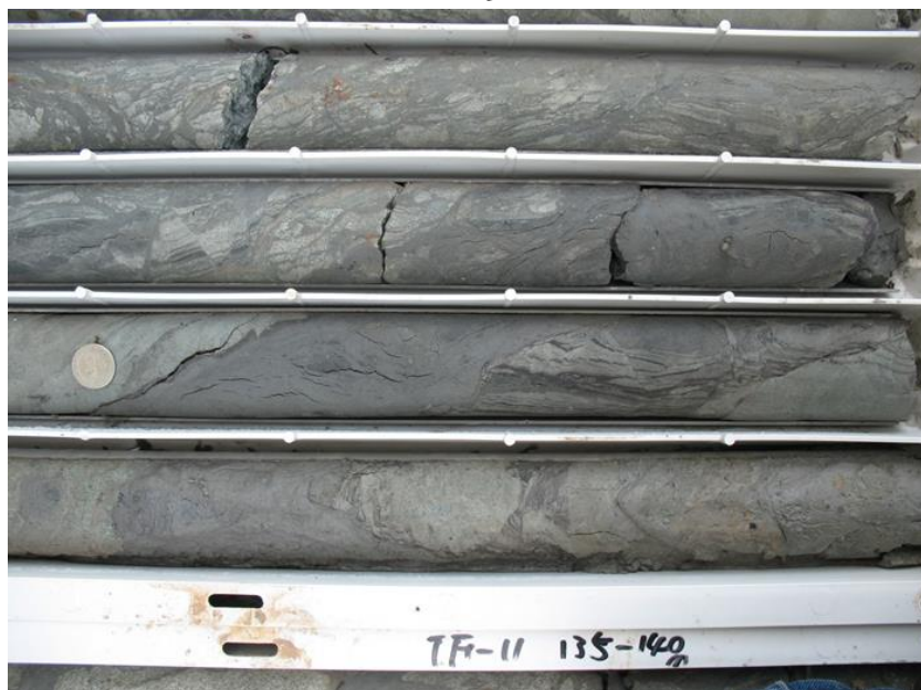
圖 4-11 北海岸福隆一帶鑽探岩心中所見之剪裂帶，砂岩部分被斷層作用剪碎為斷層角礫岩。
